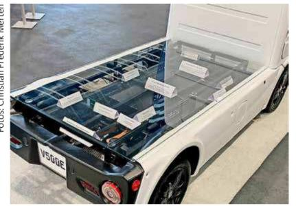
Der Akku des Sevic V500e ist im Boden der Plattform verbaut.
