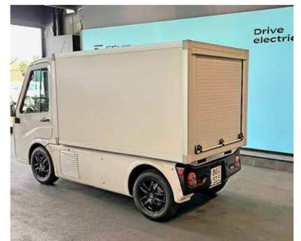
Koffer (Bild) oder Pritsche – das sind die Standard-Aufbauten des Sevic V500e. Sie lassen sich einfach per Gabelstapler tauschen.
