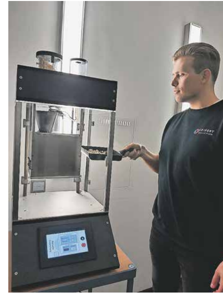
Induktive Wärme für das Popcorn: Systemelektroniker Kevin Tönjes hat im Laufe des Wettbewerbs ein Produkt entwickelt. Foto: Privat
