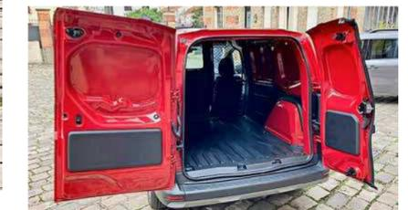
3,9 Kubikmeter Fracht schluckt der kurze Townstar EV (Bild) maximal, beim großen sind es 4,9 Kubikmeter.
