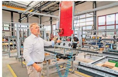
Eigenkonstruktion: Diese Apparatur bringt Druckluft, Teile und Co. dahin, wo sie am Montageplatz gebraucht werden.
