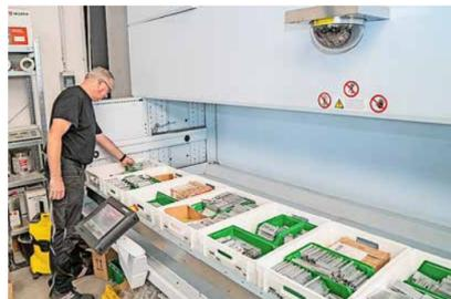
Kleiner Ausschnitt des vertikalen Teilelagers. Hier lagern Kleinteile in Gondeln. Staufläche: 240 Quadratmeter.
