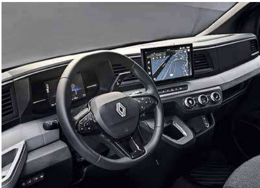
S-förmiges Cockpit im neuen Renault Master, Zehn-Zoll-Touchscreen und Automatikwählhebel am Lenkrad für mehr Platz
